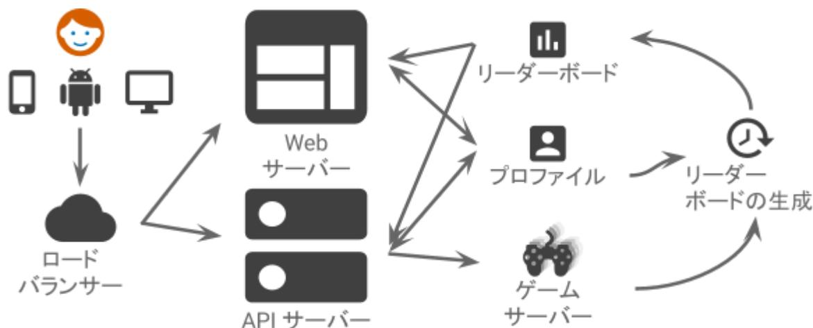
ゲームにはモバイル クライアントとWeb UI の両方があります。モバイル クライアントは、提供しているインフラストラクチャと RESTful HTTP 上でやりとりされる JSON RPC メッセージを使って、リクエストを送信します。また、ゲームの状態のアップデートを受信するための WebSocket 接続を維持します。ブラウザは HTTPS 経由でWebサーバーと通信します。リーダーボードは 5 分ごとに更新されます。
