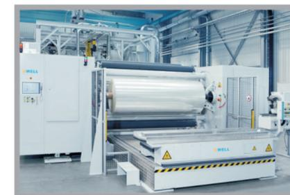
**PP、PS、ABS、PE Sheet Extrusion Line**
